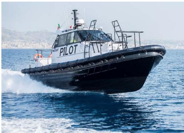
all'esterno. Il volume interno della cabina è stato reso flottante rispetto alla struttura per minimizzare rumore e vibrazioni.
